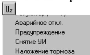
Эти элементы в активном состоянии передают в основную систему соответствующий сигнал. "Аварийное откл." – аварийно отключает КТЭ, "Предупреждение" – выдает сигнал предупреждения, "Снятие УИ" – переводит КТЭ в режим "останов", "Наложение тормоза" – выдает сигнал наложения механического тормоза. При прохождении данных сигналов основная система КТЭ выдает соответствующее сообщение на пультовый терминал.
