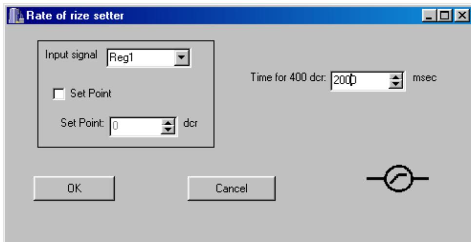
Т.е. в качестве входного сигнала используем выход элемента Reg1, темп равен 2000 ms на 400 дискрет.
