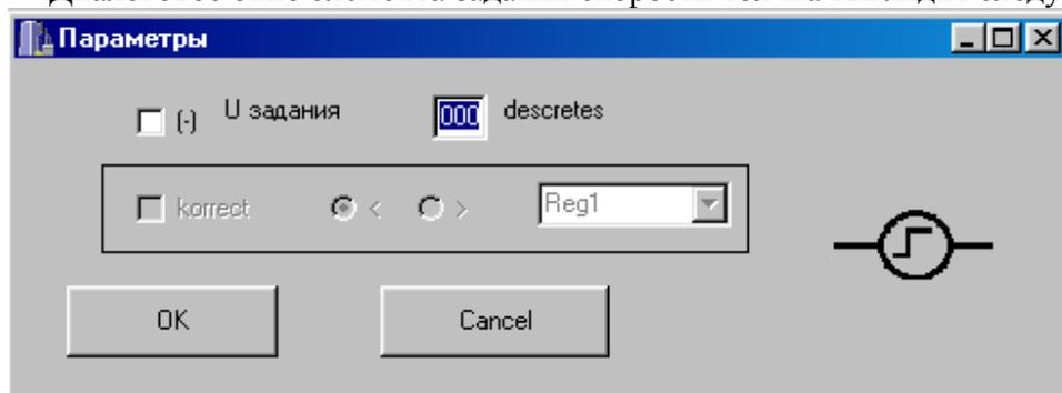
Здесь устанавливается величина скорости толчка и полярность. Толчки подаются при активном элементе задания толчка. При неактивном элементе задания толчка, задание снимается (а не запоминается в отличие от элементов ЗИ). При наличии на схеме нескольких активных элементов задания скорости толчка, величина задания скорости, передаваемая в контроллер, вычисляется как сумма с учетом знака. При необходимости ЗИ следует воспользоваться элементом "Темп ЗИ толчка".
