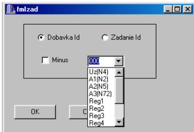
При активном элементе в КТЭ передается задание тока (или добавка), при неактивном передается ноль задания тока или последнее активное значение добавки тока (если выбрана добавка). Т.е. при использовании элемента в качестве добавки тока, значение необходимо обнулять. Флаг "Minus" инвертирует аналоговую величину, или устанавливает отрицательную константу.
