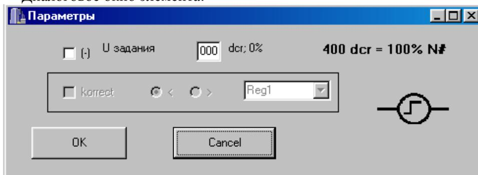
Задание толчка устанавливается константой. При неактивном элементе его значение равно нулю. При наличии нескольких активных элементов задания толчка, величина задания складывается. При необходимости можно установить темп задатчика интенсивности толчка с помощью элемента "Темп ЗИ толчка".
