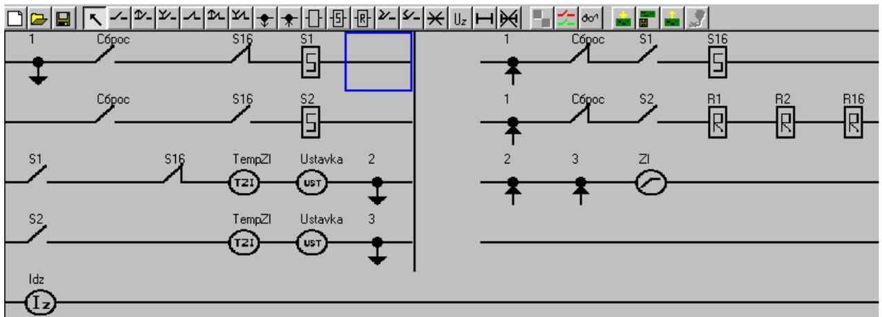
В качестве входного сигнала элемента ЗИ выбрана "Уставка". Темп ЗИ задается внешним элементом "Темп ЗИ, ИЗУ". В качестве входного сигнала элемента задания тока выбран выход ЗИ. Катушки триггеров S1, S2, S16, R1, R2, R16 реализуют требуемый алгоритм с нажатием кнопки "Сброс". Нормально открытый контакт триггера S1 подключает темп ЗИ 25сек/400 дискрет и "Уставку" 200 дискрет (100% номинала тока). Нормально открытый контакт триггера S2 подключает темп ЗИ 25сек/400 дискрет и "Уставку" 0 дискрет.
