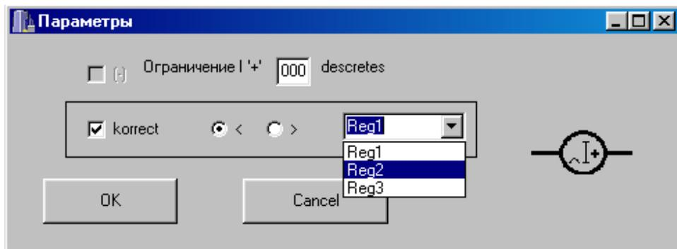
В КТЭ передается ограничение текущего активного элемента. Если в проекте отсутствуют элементы "Ограничение тока", ток ограничивается уставками основной системы. При наличии нескольких элементов ограничения тока в проекте, в основную систему передается значение последнего активного элемента (программа выполняется сверху вниз, слева направо).
