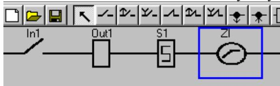
то при наличии дискретного входа In1 будут одновременно включаться: дискретный выход Out1, S-катушка триггера 1 и задатчик интенсивности.
