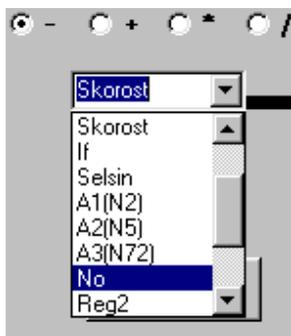
Кнопками выбирается арифметическое действие, которое будет производить элемент. Если производится деление, то коэффициент элемента изменяется от 1 до 255, при других действиях от 0.1 до 25.5.
