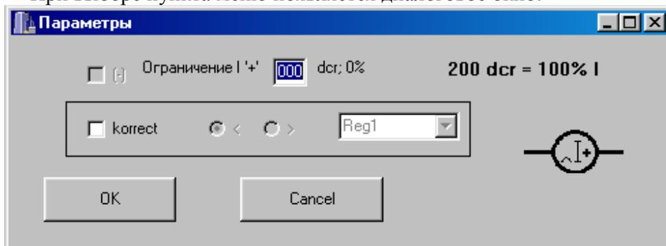
В качестве ограничения задается константная уставка в дискретах (200 дискрет соответствуют 100% номинала тока). При необходимости корректировки ограничения тока, следует установить флаг "correct". Для корректировки могут быть использованы выходы элементов "Регулятор". Если выбран знак "<", значение корректирующего сигнала будет вычитаться из уставки токоограничения. Если выбран знак ">" значение корректирующего сигнала будет прибавляться. Следует учитывать знак корректирующего сигнала.
