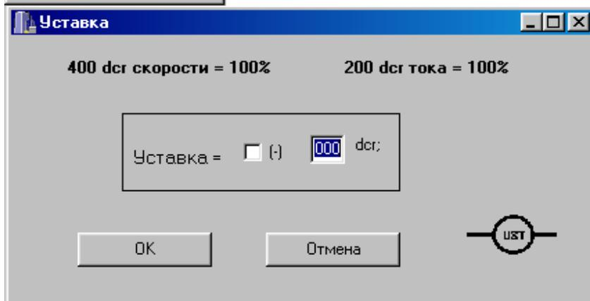
Значение элемента может быть использовано в ЗИ, регуляторах, элементах сравнения, элементах задания тока. Значение уставки устанавливается равным суммарному значению всех активных
