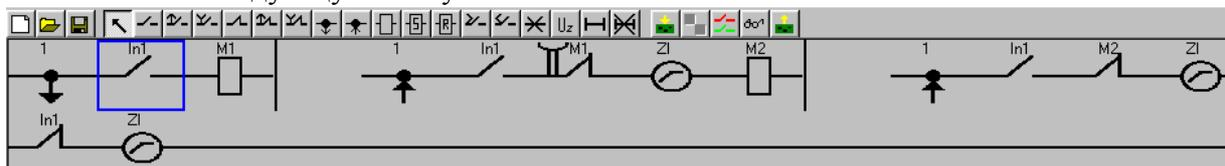
Время задержки контакта M1 устанавливаем 2000ms. Параметры ЗИ в первой линии: Set Point – 400 dcr, темп 20000ms на 400 дискрет, Параметры ЗИ во второй линии: Set Point – 400 dcr, темп 1000 ms на 400 дискрет.
