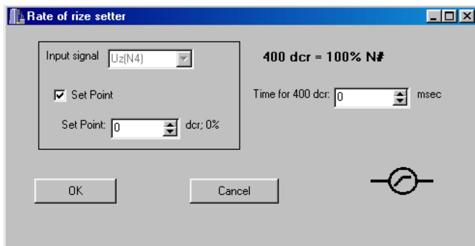
Элемент управления реализует функцию задатчика интенсивности нарастания скорости. Уставка темпа устанавливается в миллисекундах на 400 дискрет задания (400 дискрет равняется 100% задания). В качестве уставки скорости может быть использована константа (флаг «Set point») установлен или аналоговая величина из списка.
